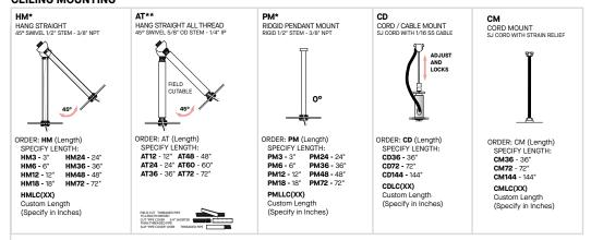
MAXIMUM ONE PIECE STEM LENGTH IS 72". \*\*MAXIMUM ONE PIECE STEM LENGTH IS 36". LONGER LENGTHS ARE POSSIBLE USING MULTIPLE STEMS AND COUPLERS.
