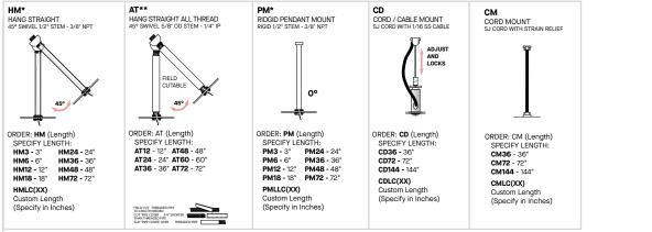
MAXIMUM ONE PIECE STEM LENGTH IS 72". \*\*MAXIMUM ONE PIECE STEM LENGTH IS 36". LONGER LENGTHS ARE POSSIBLE USING MULTIPLE STEMS AND COUPLERS.
