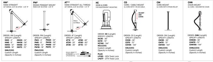
\*MAXIMUM ONE PIECE STEM LENGTH IS 72". \*\*MAXIMUM ONE PIECE STEM LENGTH IS 36". LONGER LENGTHS ARE POSSIBLE USING MULTIPLE STEMS AND COUPLERS.
